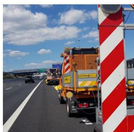
Figura 16: dotazione standard di lampade sul lato dell'autocarro esposto al traffico da utilizzare, ove richiesto dagli schemi, nei cantieri il lento movimento o in lento avanzamento. Il set è composto da 3 lampade a led diametro 200 mm a luce fissa omologate L8H.
